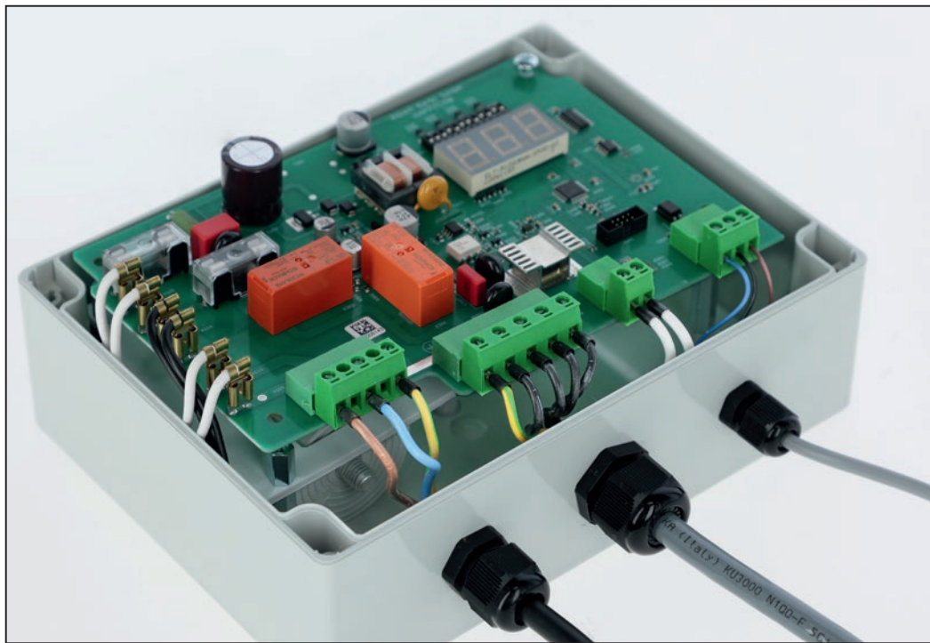
Рисунок 9. Плата в корпусе блока управления (конденсатор позади платы)
