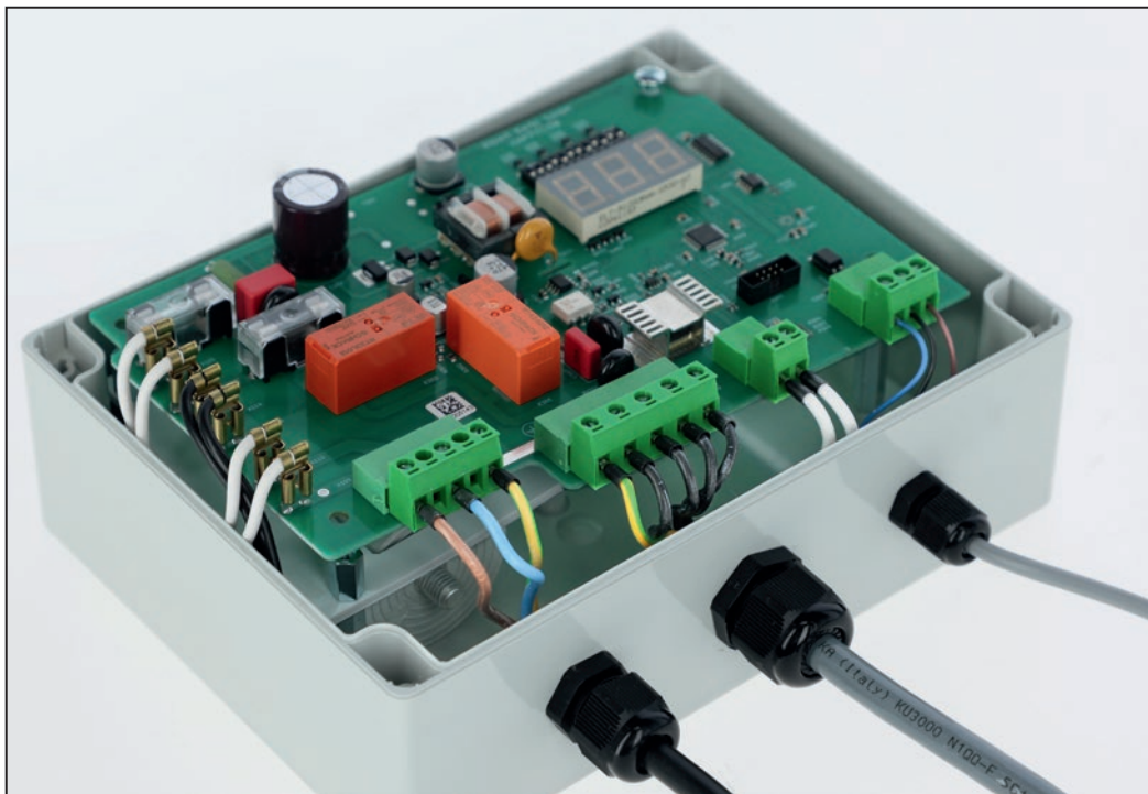
Bild 9: Kretskort i styrsystemhöljet (kondensator bakom kretskortet)
