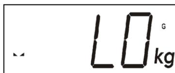
Sie befinden sich im Menü für die Festsetzung der unteren Grenze. Es wird für 2 Sekunden LO angezeigt. Danach wird automatisch das voreingestellte Gewicht von 119,0 kg angezeigt.
