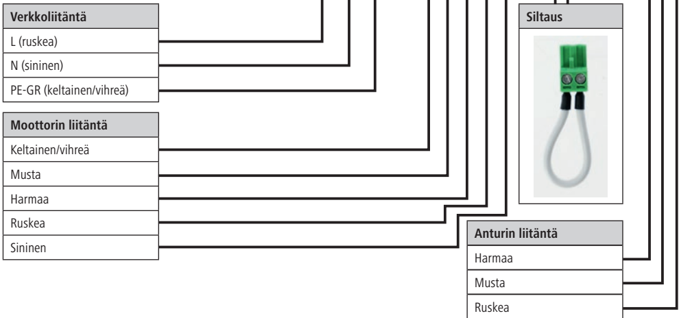
Kuva 8: Piirilevyn ja kondensaattorin kytkentäkaavio - MaxiSwing
